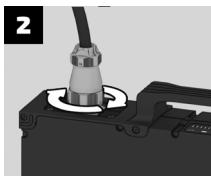
Visse le connecteur à baïonnette du chargeur sur la batterie : les flèches l'une en face de l'autre. Fixe ensuite le connecteur en le tournant dans le sens des aiguilles d'une montre, il doit bien faire 'clic'.
