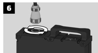
Als de accu voldoende is opgeladen, draai de bajonetssluiting op de accu los.
