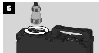
Wenn die Batterie genug geladen ist, schraube den Bajonettverschluss der Batterie ab.
