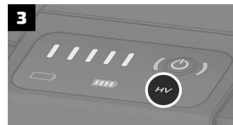
Controleer of het 'HV' led op de accu oplicht. Licht hij niet op? Koppel dan de lader opnieuw tot het 'HV' led oplicht.
