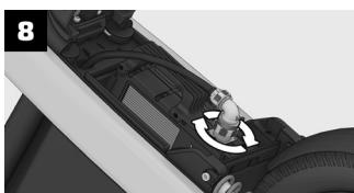
Reconnecte ensuite la batterie au Brekr. Visse le connecteur à baïonnette en le tournant dans le sens des aiguilles d'une montre, il doit bien faire 'clic'.
